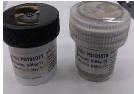
Figura 32 Pasta epóxica de plata. Del lado izquierdo la pasta epóxica con polvo de plata y del lado derecho endurecedor con polvo en plata.
