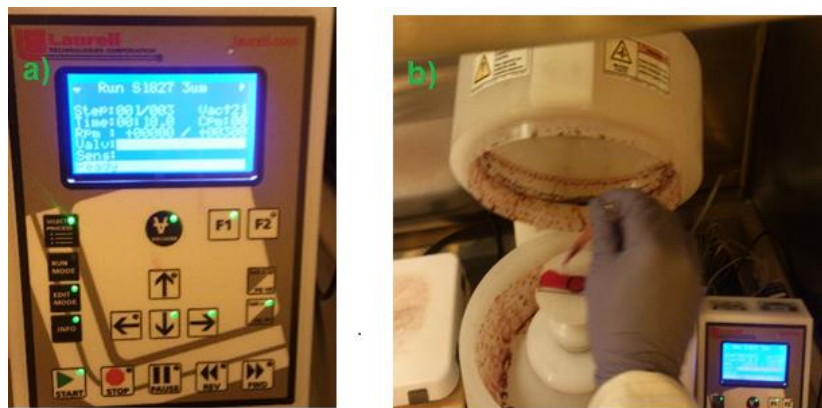
Figura 96 a) selección del programa S1827 en el Spin-Coater; b) Deposito de resina en el sustrato previo a correr el programa S1827 para uniformidad de 3 [ \mu\text{m} ].
