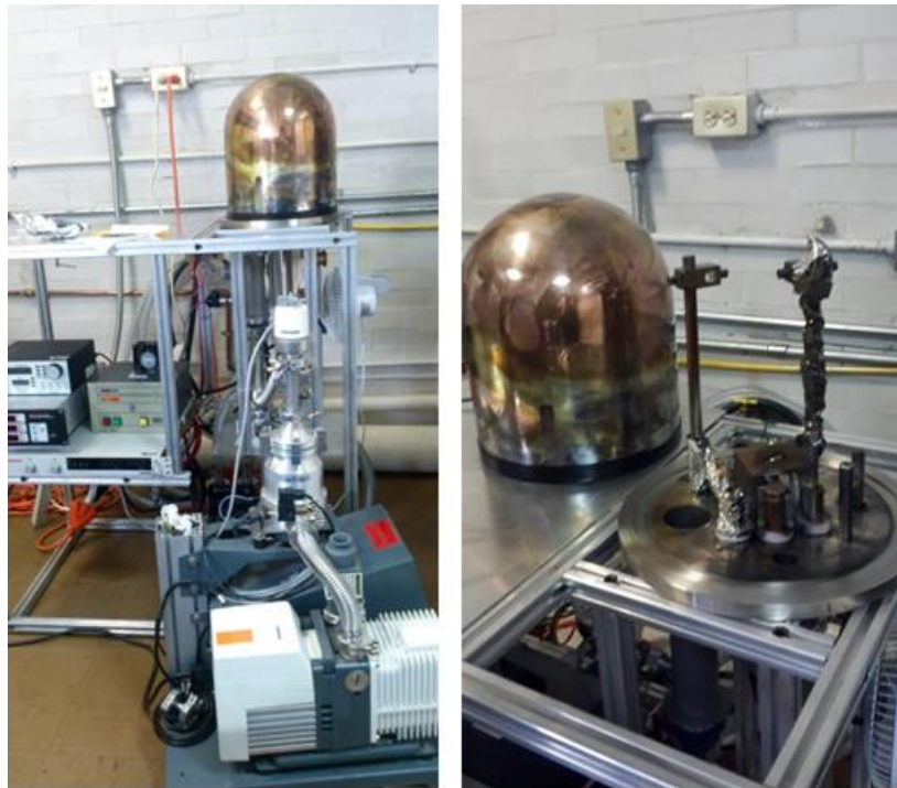
Figura 24 Fotografía del equipo de evaporación por resistencia del Laboratorio de Óptica y Microondas del CCADET
