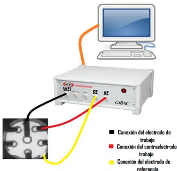
Figura 49 Diagrama de conexiones del arreglo de microelectrodos con el sistema comercial GillAC
