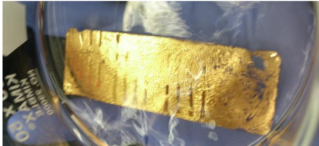
Figura 99 Remoción de la resina y metal excedentes en el sustrato.
