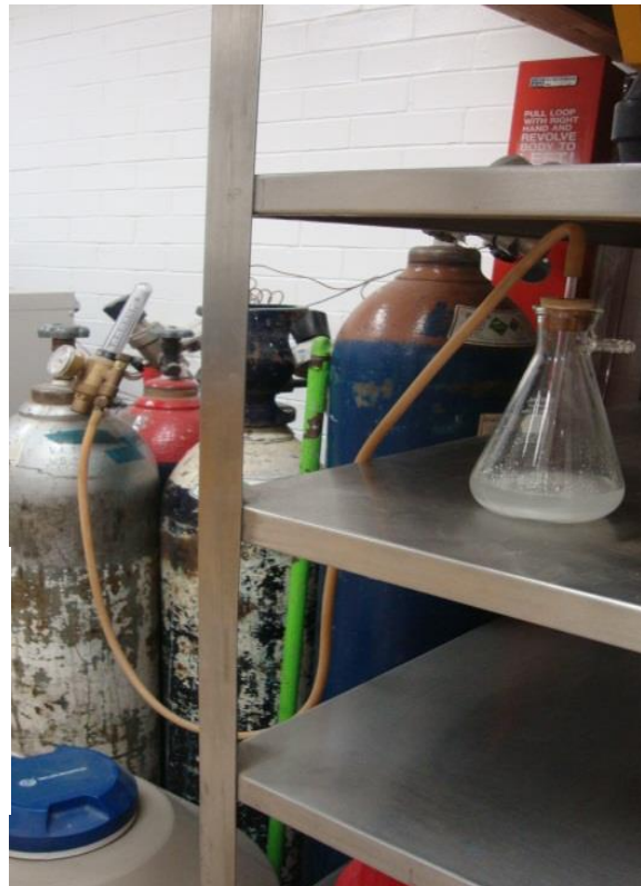
IMAGEN 4. En la imagen se muestra el matraz kitazato al cual se le está burbujeando el dióxido de Carbono a presión y temperatura conocidas
