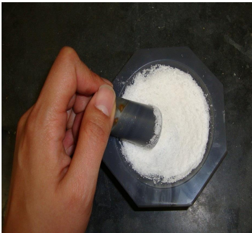
IMAGEN 3. En la imagen se muestra pulverización del precipitado.
