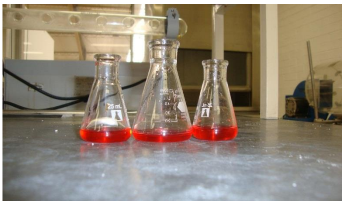
IMAGEN 5. La imagen muestra cómo queda la solución una vez valorada, cuando el vire cambio de rojo a anaranjado rojizo.
