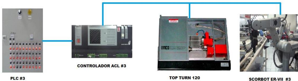
Figura 56. Dispositivos conectados en la estación de maquinada por Torno.
