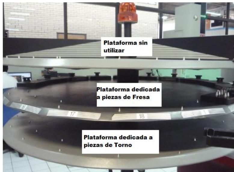
Figura 60. Disposición de piezas almacenadas por plataforma del Almacén.
