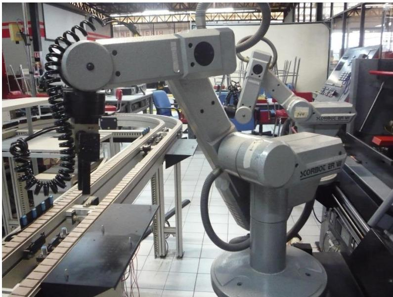
Figura 19. Robot SCORBOT ER-VII del Laboratorio de Manufactura Avanzada.
