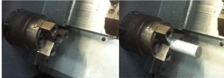
Figura 58. Chuck Neumático.
