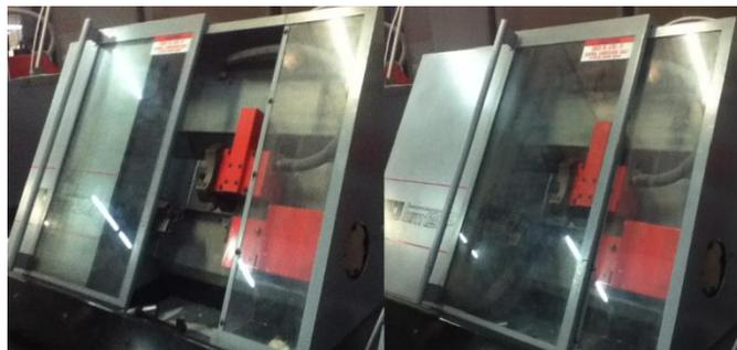
Figura 57, Puerta neumática torno.
