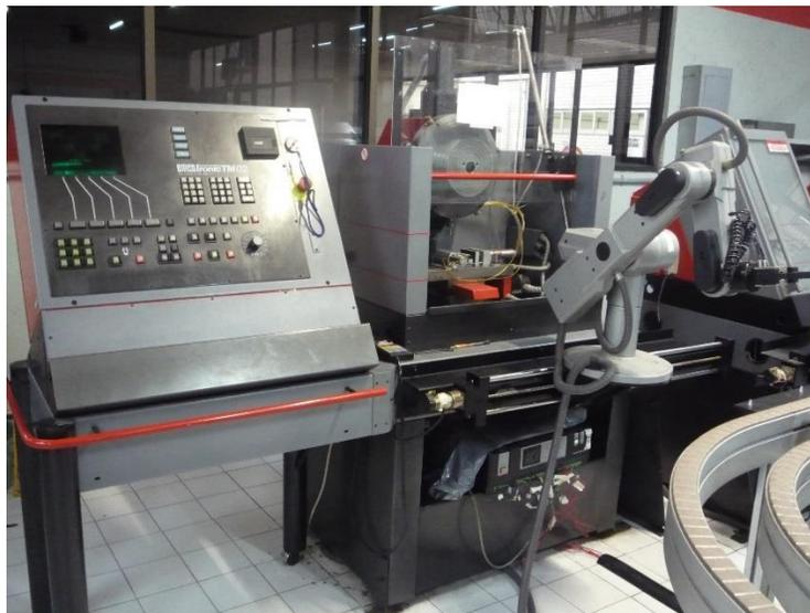
Figura 35. Fresa de control numérico del laboratorio de manufactura avanzada
