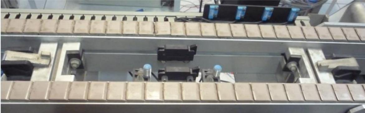
Figura 47. Sistema de sensores y topes neumáticos.
