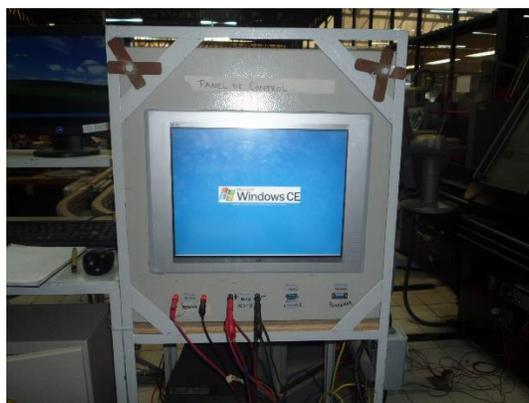
Figura 31. Interfaz humano máquina del laboratorio de manufactura avanzada. La pantalla LS XP90, es la computadora central CIM que provee un control centralizado de la producción SMF, y realiza la comunicación con las estaciones y
