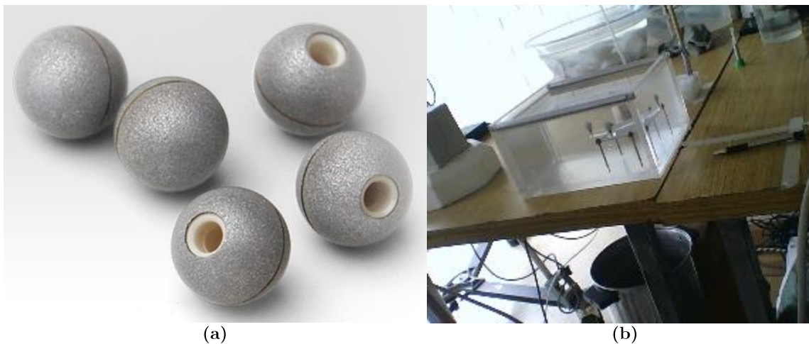
Figura 6-1. (a.) Esfera reflectora de infrarrojo. (b.) Esfera sumergida en una bandeja con agua para ser escaneada.
