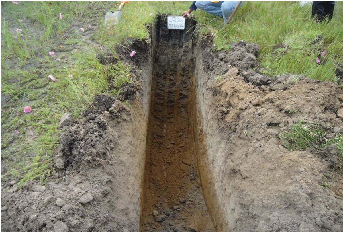
Figura 6.5 Pozo a cielo abierto
