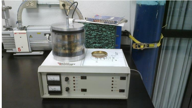
Figura 21. Equipo de pulverización catódica para recubrimientos de oro.
