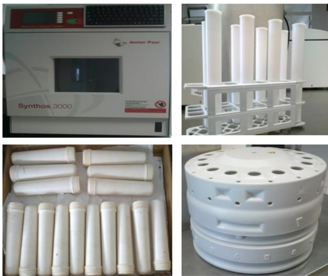
Figura 9. Equipo de microondas utilizado en la síntesis de HAp
