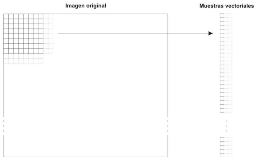
Figura 4.5. Lectura de la imagen a través de ventanas y transformación a vectores
