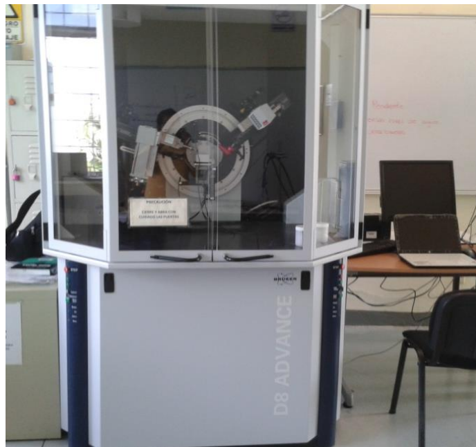
Figura 17. Difractometro utilizado en el trabajo de investigación
