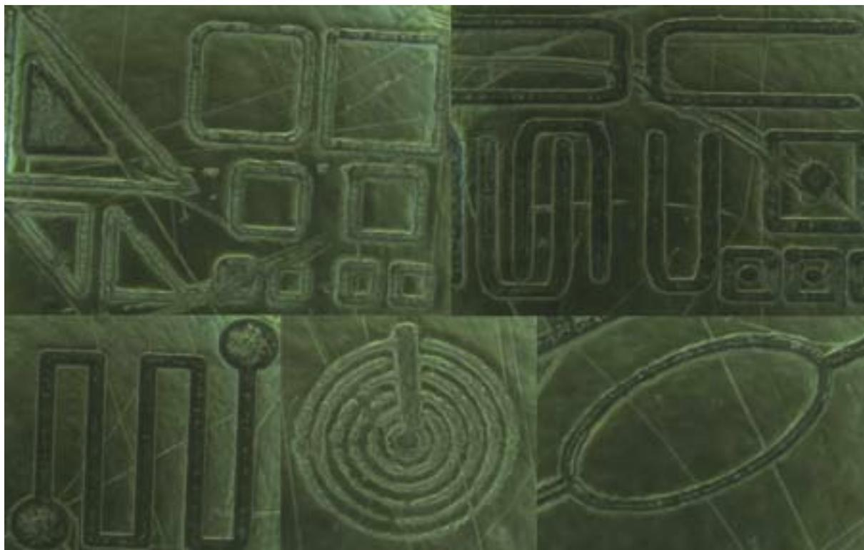
Fig. 5.1 Estructuras en réplica de PDMS
