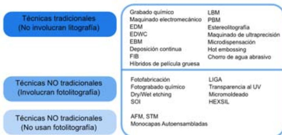
Figura 1.1 Clasificación de las técnicas de microfabricación por Marc J. Madou. [I.5 p.3]
