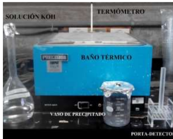
Figura 3.6 Instrumentación para el grabado químico mediante la metodología de TNS (PAD, IFUNAM).
