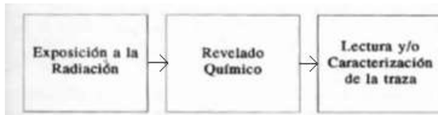
Figura 1.3 Diagrama en donde se muestran los pasos del método de detección por trazas en sólidos.
