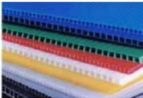
El **Polipropileno corrugado** es una lámina resistente a solventes, aceites y agua. Es rígido y permite rotular en él directamente o por medio de viniles. Sin embargo, al ser corrugado es posible que la apariencia acanalada traspase el vinil en caso de utilizarlo.
