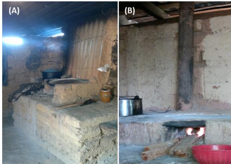
(A) Fogón cerrado con plancha (B) Fogón cerrado con plancha y chimenea (estufa ahorradora tipo Lorena). Foto: Omar Salgado
