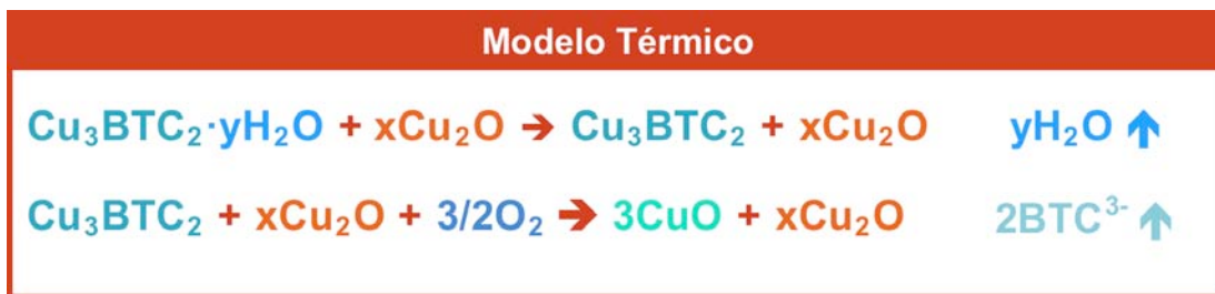
Figura 5.2.6 Modelo de descomposición térmica del CuBTC.
