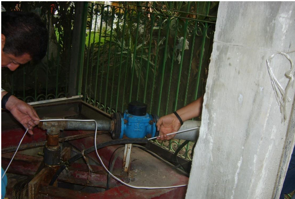
Fig. 43 y 44 Fotografías que muestran la toma de datos con sonda eléctrica.
