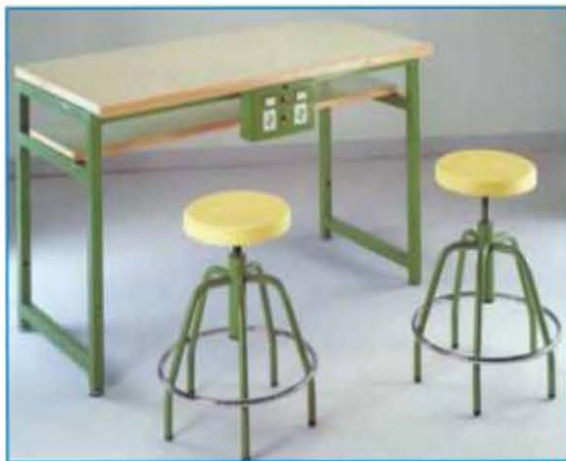
Mesa de laboratorio , estructura metálica, pintada con polvo epoxy verde, tablero en madera aglomerada de 30 mm, estratificada plástico, canteado en madera de haya, instalación eléctrica, 130
