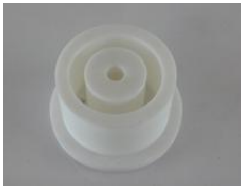
Figura 6.1: Cámara de descarga diseñada en Nitruro de Boro.
