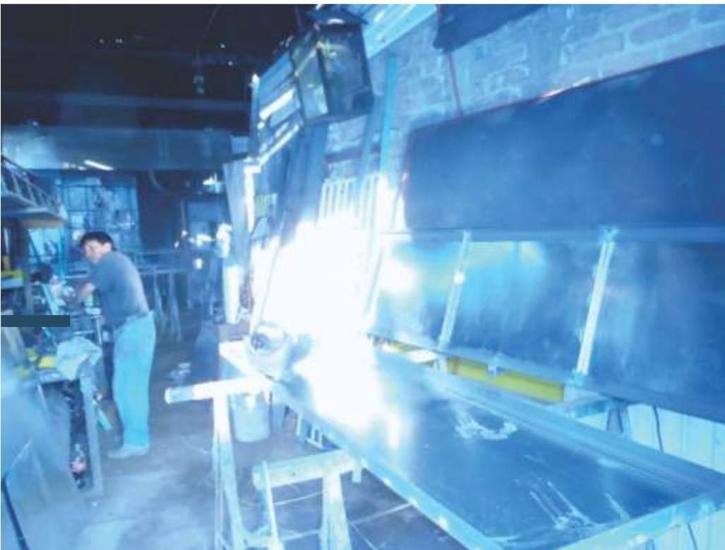
Corte del material galvanizado para la fabricación de los anuncios
