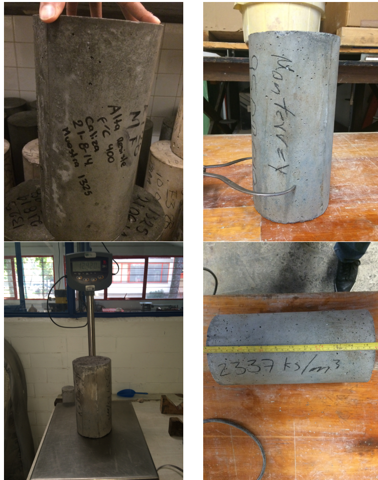
Figura 3.6: Inspección y medición de cilindros de concreto
