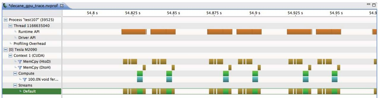
**Figura 7.4:** Línea del tiempo parcial. Perfilamiento del cálculo SOS-MP2 con la herramienta NVIDIA *Visual Profiler* para decano, base triple- $\zeta$  cc-pVTZ. A diferencia de la figura 7.1, en este caso el parámetro que determina el tamaño umbral para particionar las matrices fue modificado de tal forma que la multiplicación de matrices  $AB = C$  es llevada a cabo dividiendo la matriz B en dos, y la operación es completada efectuando dos multiplicaciones de matrices.
