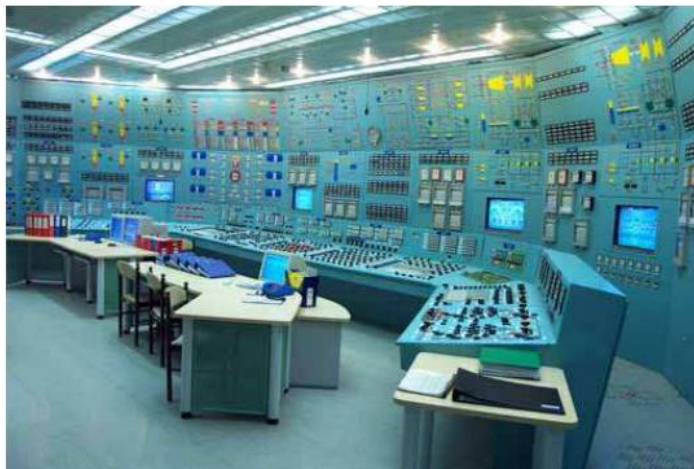
Figura2-1. Simulador de alcance completo en réplica de cuarto de control
