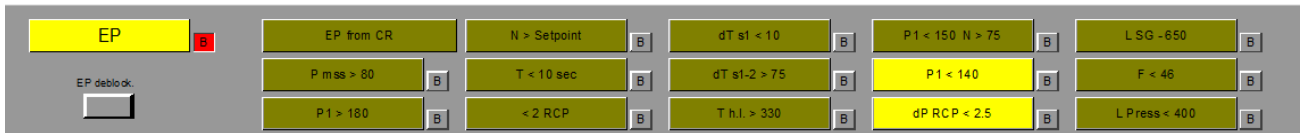
Figura 3-5. Señales de protección de emergencia y botones para bloqueo
