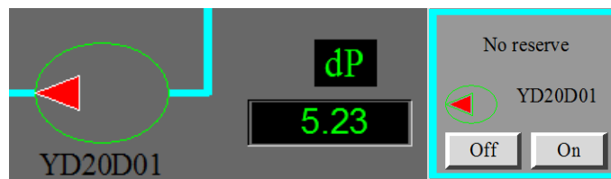
Figura 3-6. Panel de operación de bombas
