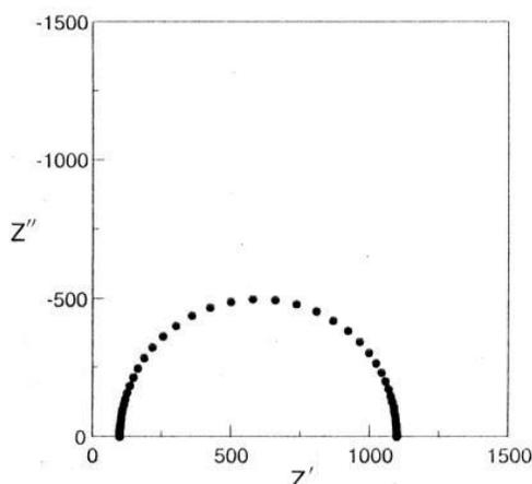
**Figura 2** Diagrama de Nyquist para el circuito de la figura 49 para  $R_s=100 \Omega$ ,  $R_p=1,000 \Omega$  y  $C_{dl}=0.0001 \text{ F}$
