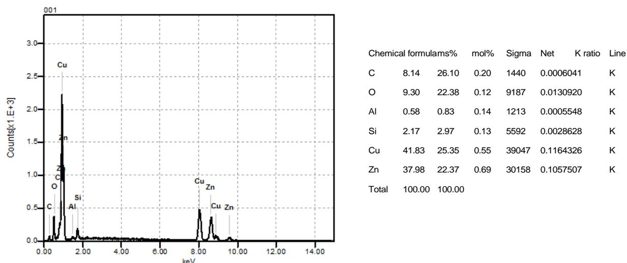
**Figura 4.7.** Micrografía de los productos de corrosión del Admiralty al ser inmerso en 1M de NaCl obtenida por el MEB a diferentes aumentos 50X y 250X de la región donde se realizó el análisis químico mediante EDX, difractograma obtenido por EDX de los productos de corrosión y la tabla de composición en 1M de los productos de corrosión.
