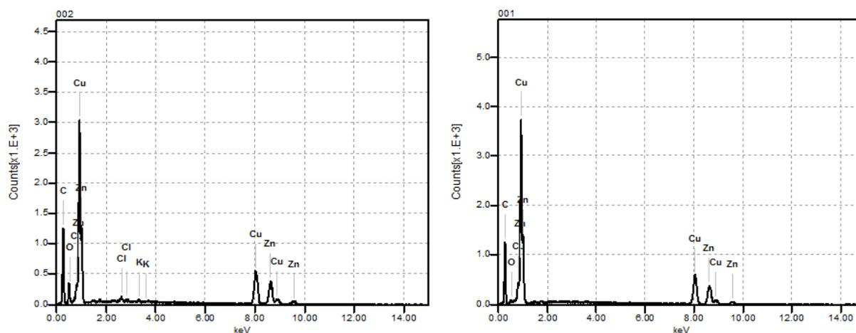
Figura 3.3. Difractograma del Admiralty obtenido por EDS.
