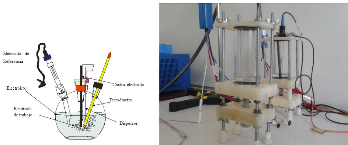
Figura 3.7. Celdas utilizadas en los ensayos electroquímicos.
