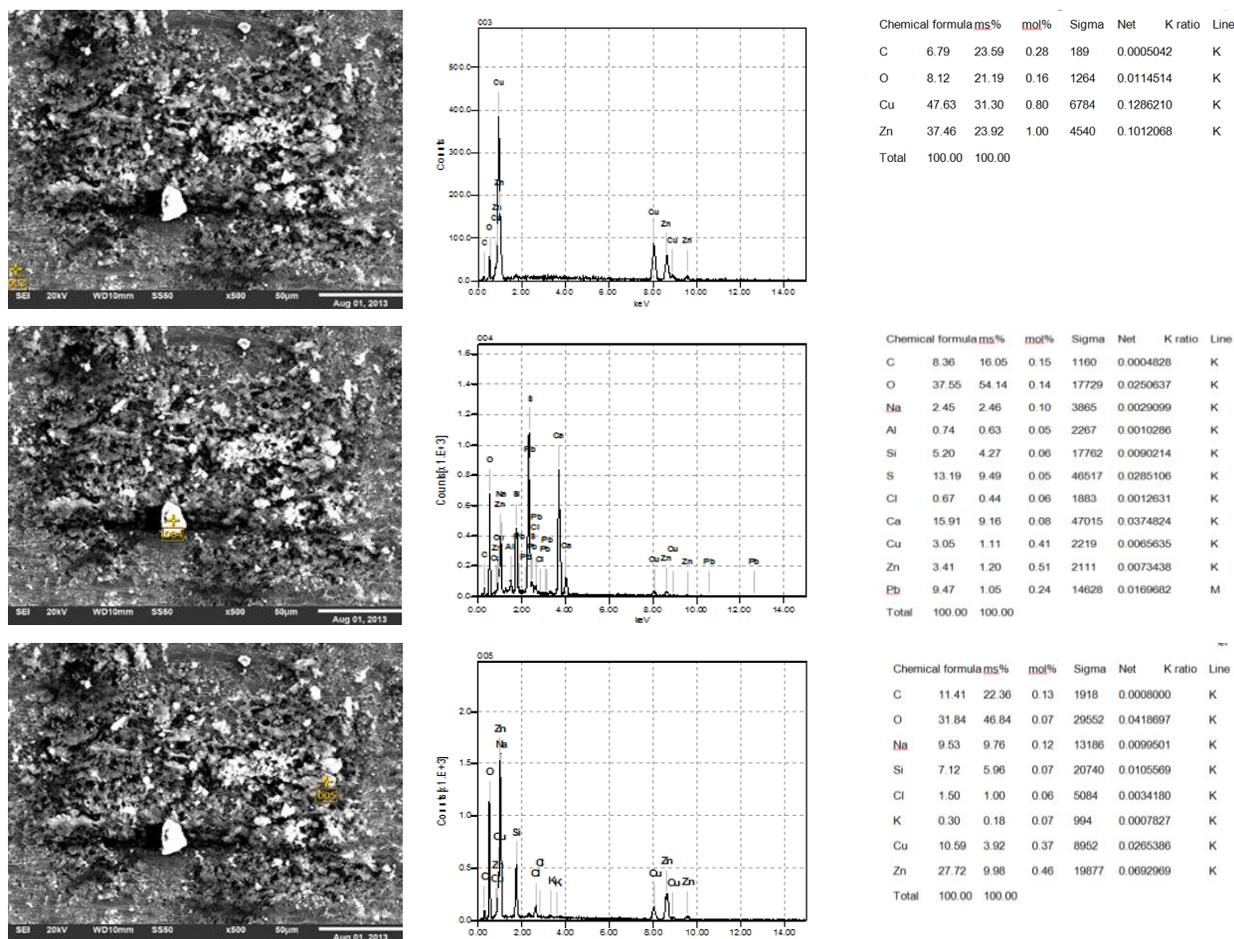
Figura 4.6. Micrografías, difractogramas y análisis químico en 3.5% en peso de diferentes productos de corrosión del Admiralty obtenida por el MEB.
