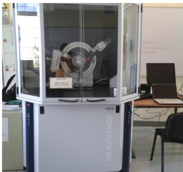
**Figura 3.4.** Difractometro utilizado en el trabajo de investigación
