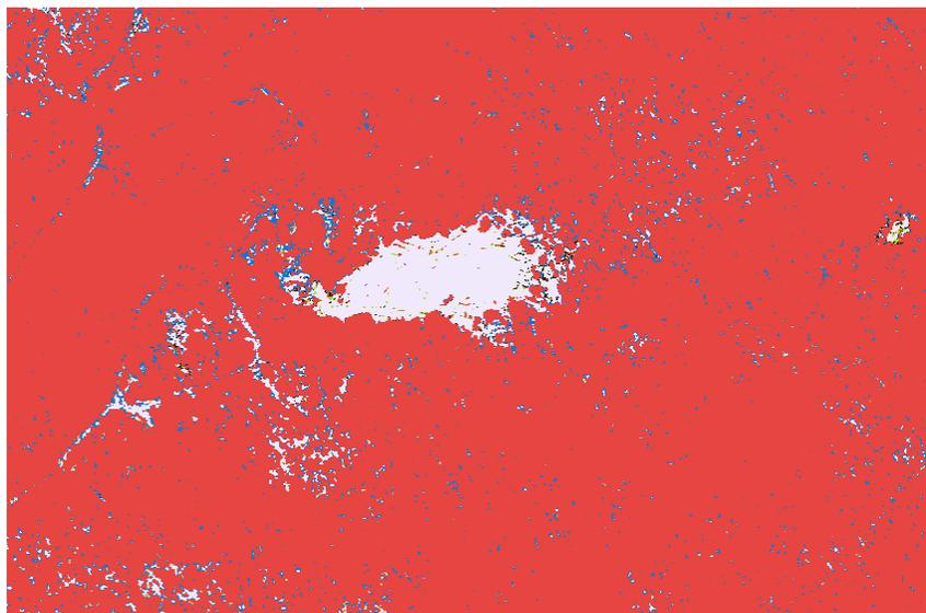
**Figura III.18. Segmentación de los cocientes de bandas. El resultado de la segmentación muestra una clara diferenciación de la firma espectral de los terreros (color blanco), del resto de los materiales que se localizan alrededor de la zona de jales (colores rojo y azul).**
