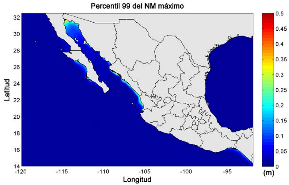
Figura 25 - Mapa del percentil 99 correspondiente al nivel del mar máximo generado por los CPO
