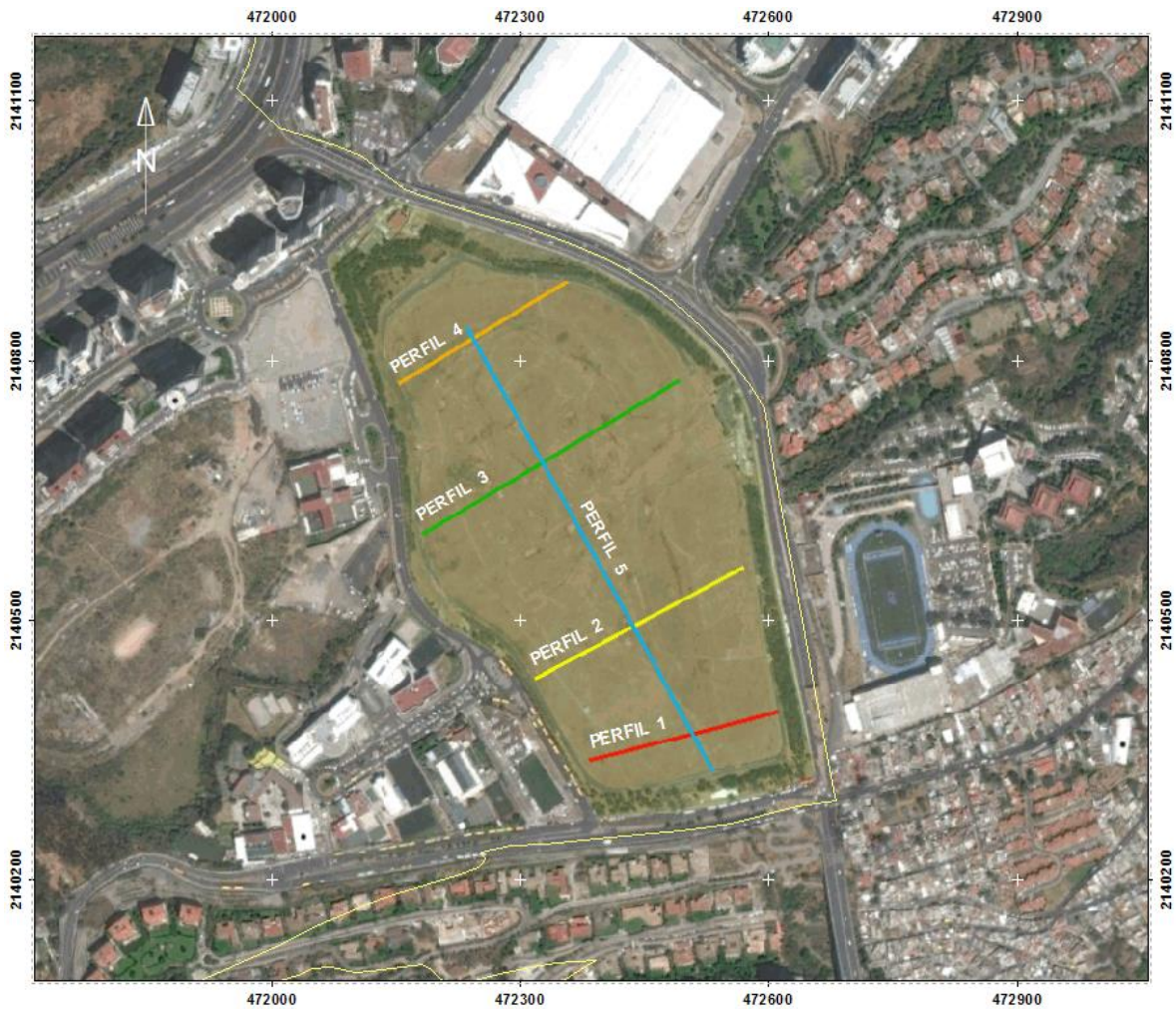
Figura 4.1. Ubicación de los perfiles de tomografía de resistividad eléctrica (TRE) en el SDF Prados de la Montaña (Google Earth, 2014)
