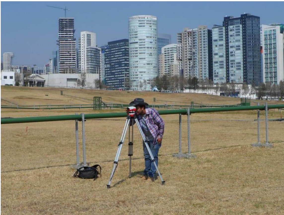
Figura 4.4. Levantamiento topográfico con nivel y estadal
