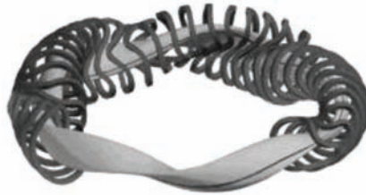
Fig. 1.9: Esquema de las bobinas y plasma en el Stellerator [3].
