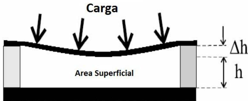
Fig. III.5: Diseño básico de un sensor de capacitancia (Fuente: Torrey R. Filac-Bowen, Guen Hyung Kim and Yuri M. Shkel, IEEE Sensors Conference, Orlando Florida, June 2002)
