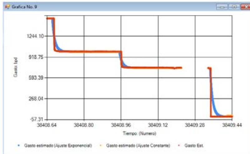
Fig. V.10: Reproducción del registro PLT mediante los modelos de correlación generados.
