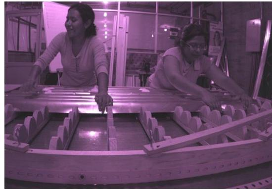
Figura 42 Molde de madera para los canales reflectores (izquierda); Colocación manual de los canales reflectores en el molde de madera (derecha)
