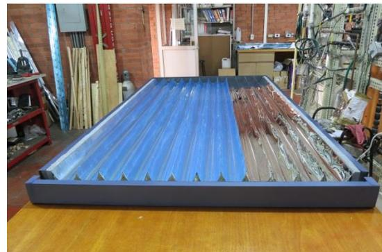
Figura 44 Remoción de la cama de reflectores del molde de madera (izquierda); posicionamiento de la cama de reflectores en el bastidor final (derecha)
