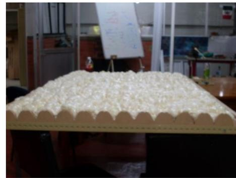
Figura 43 Espuma de poliuretano para fijar los canales reflectores entre ellos (izquierda); capa final de espuma de poliuretano para rigidez y aislamiento térmico (derecha)
