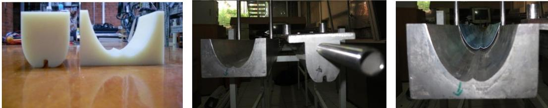
Figura 41 Prototipo en nylamid a 10cms de largo para el Dado-Prensa que deforma las láminas de Alanod® (izq); Dado-Prensa que deforma las láminas de Alanod® de 1.95m de largo (en medio); parte hembra del Dado-Prensa con láminas de Alanod® ya deformada (der)
