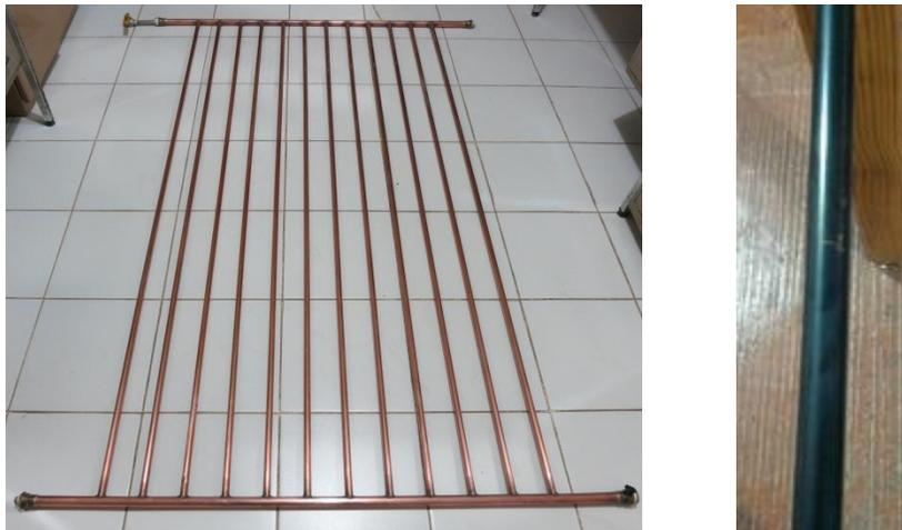
Figura 45 Enrejado de cobre sin recubrimiento (izquierda); Tubo con recubrimiento utilizado (derecha)
