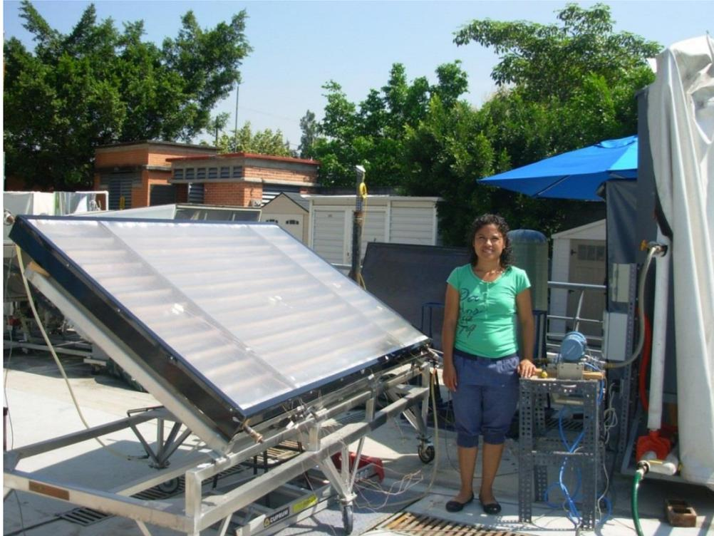
Figura 47 Colector CPC con receptor cilíndrico convencional y factor de concentración 1.5 montado en el banco experimental
