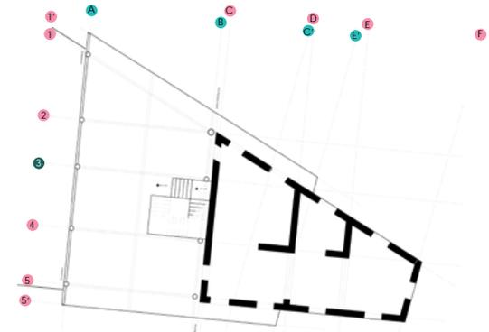
La estructura vertical del edificio antiguo es a base de muros portantes de tabique rojo. Se respetan sus ejes existentes: 1, 2, 4, 5, C, D, E y F. Los entrepisos se mantienen de vigas de madera. Sólo se modifica la cubierta de cerramiento en su lado exterior por la pendiente de escurrimiento y la colocación de un piso flotado.
