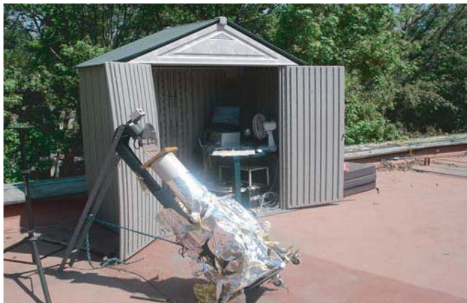
Figura 6. Primera configuración utilizada para medir espectros de absorción solar en el CCA-UNAM
