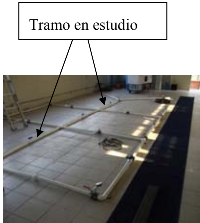
Figura 7.1.7 Tubería simple, en modelo experimental.
