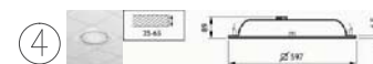
Lampara fluorescente Rotafis TBS741 c/1 lampara de 80 Watts con pantalla de una lampara y panel de cristal de(597x88) iluminacion semidirecta.
