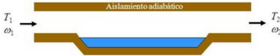
Ilustración 1.5 Conducto aislado térmicamente
