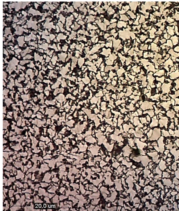
Figura 4.42 Micrografía de acero hipoeutectoide, de llegada. Nital 2.
