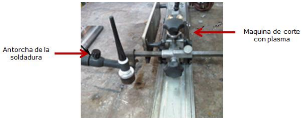
Figura 4.1.- Antorcha de la soldadura del proceso GTAW adaptada a una máquina de corte con plasma.
