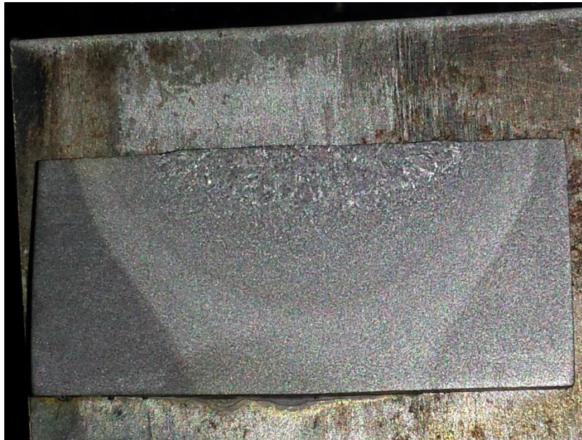
Figura 4.7.- Ataque macro realizado a soldadura del material tipo A.
