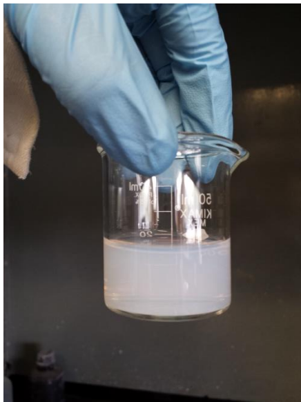
Figura 4.3.- Formación del precipitado blanco en la reacción.
