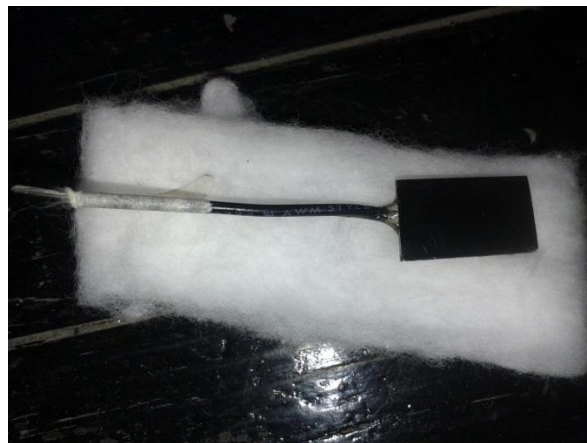
Figura 4.2.- Probeta preparada para el cargado con hidrógeno y decoración con plata
