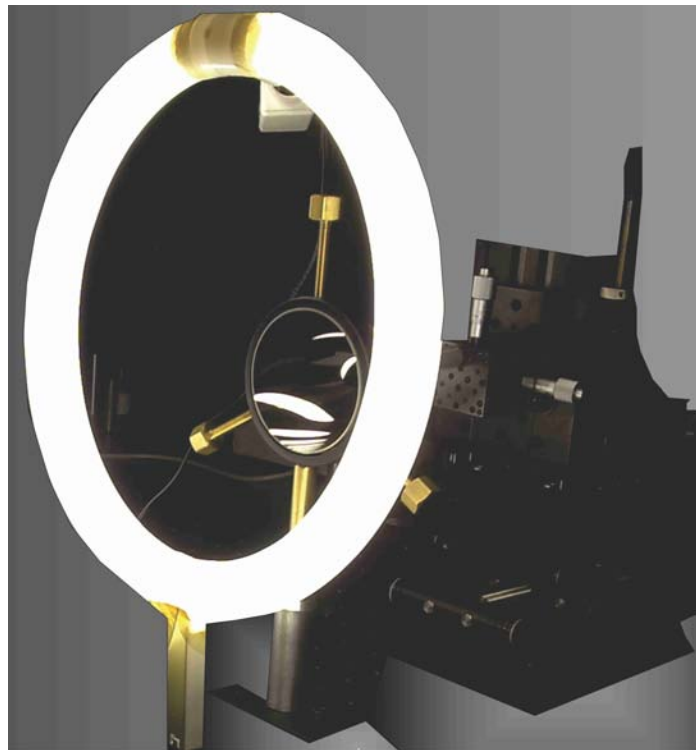
Figura 1.17: Iluminación del sistema bajo prueba, espejo con F/0.147.
