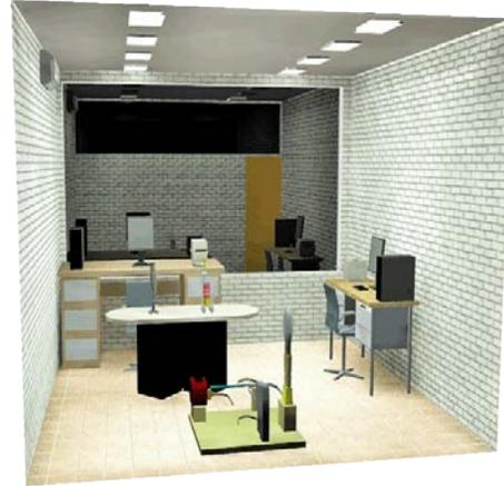
En la figura 3 se muestra la simulación de los sanitarios de este edificio la altura de este recinto es la misma que en todo el edificio de 3.4 m la altura del montaje de luminarias en específico para este tipo de áreas es de 2.94 m debido a que el tipo de luminarias propuestas para los sanitarios es tipo suspender mientras que para el resto del edificio son tipo empotrar.
