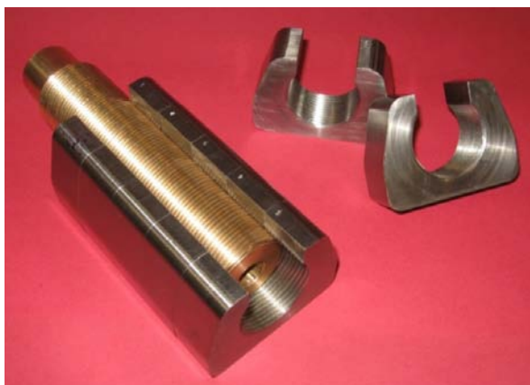
Figura 2.4. Cuerpos roscados y tornillo de bronce del reductor propuesto
