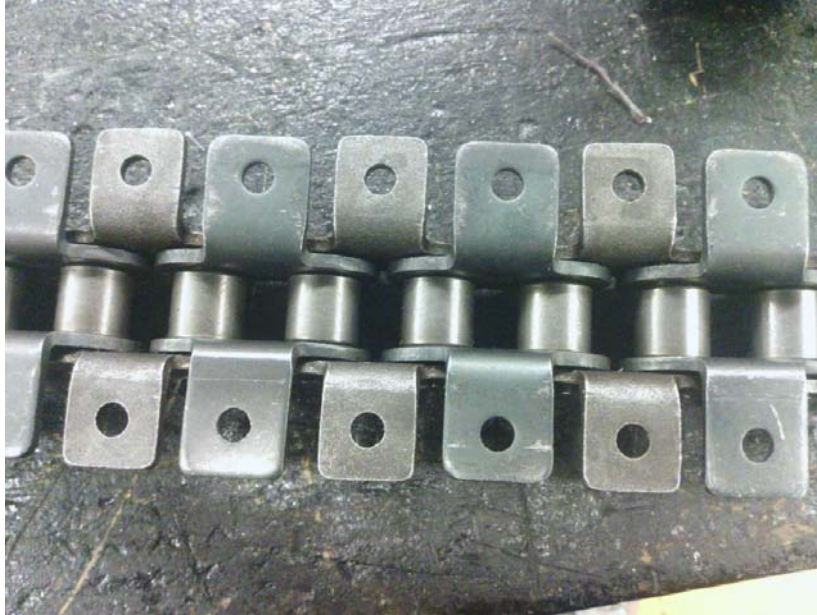
Figura 3.2. Cadena de rodillos comercial con aditamento K1
