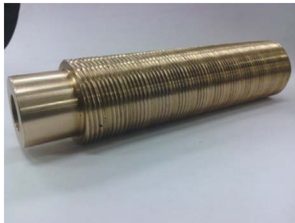
Figura 1.6. Tornillo de bronce fabricado para pruebas
