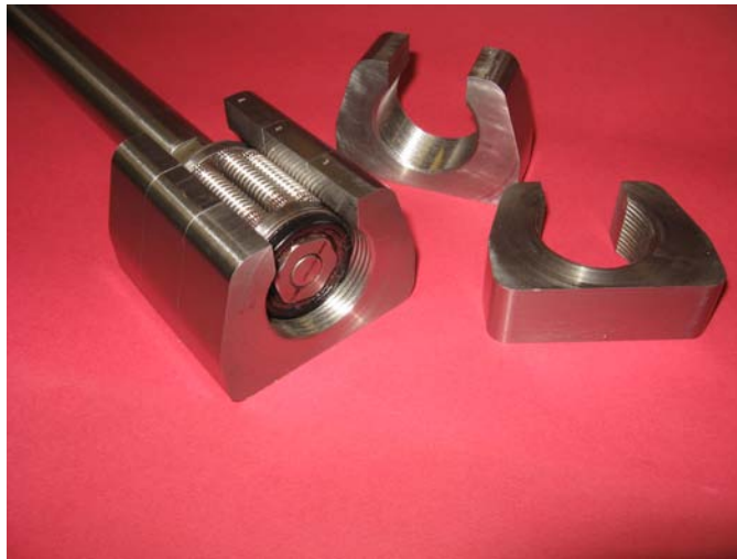
Figura 1.9. Tornillo de rodillos y cuerpos roscados
