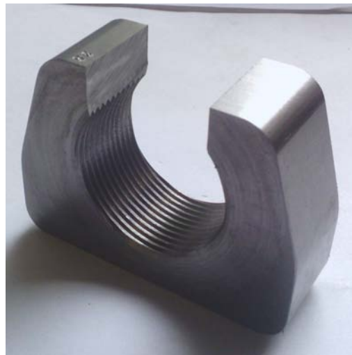
figura 1.4. Cuerpo roscado manufacturado
