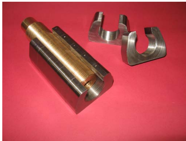
Figura 1.8 Tornillo de bronce y cuerpos roscados
