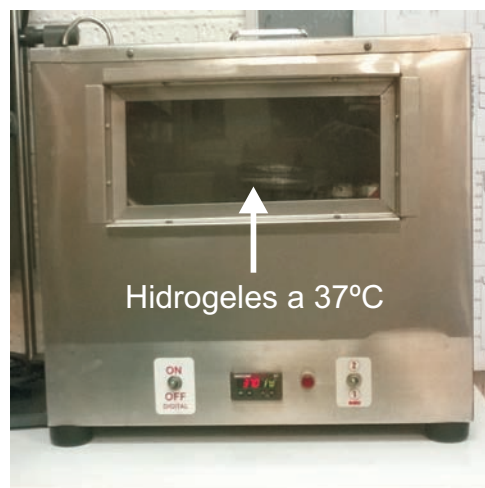
(c) Almacenamiento de las muestras en un baño de agua a 37 °C.
