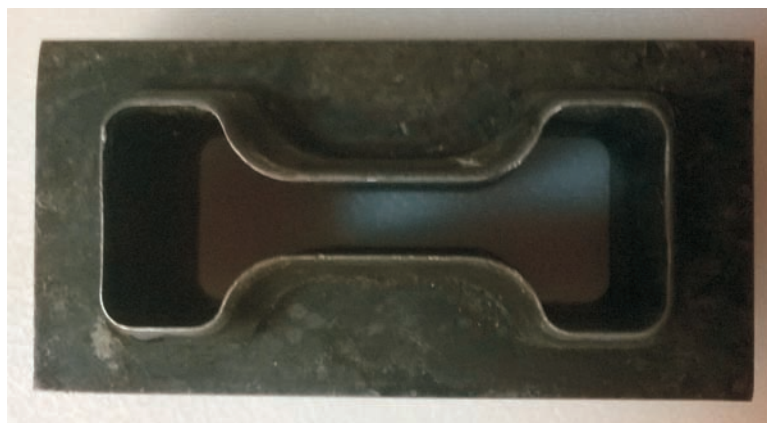
Figura 2.13: Suaje utilizado para cortar las probetas de hidrogel.
