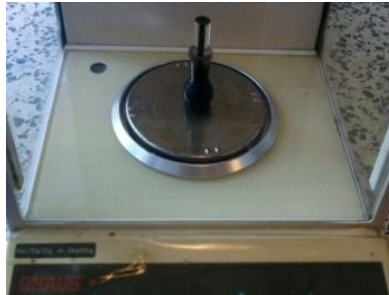
Figura 4.8 Picnómetro con muestra de aceite siendo pesado.
