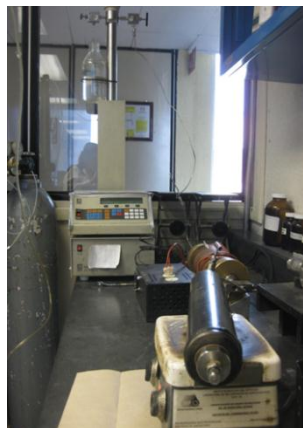
Figura 4.11 Bomba de Inyección con la cual se saturaron las muestras de roca de aceite.
