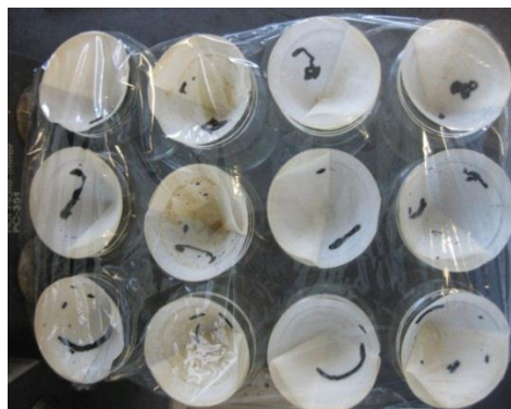
Figura 4.24 Secado del papel filtro para obtener el peso del aceite recuperado
