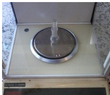
Figura 4.7 Picnómetro vacío siendo pesado.
