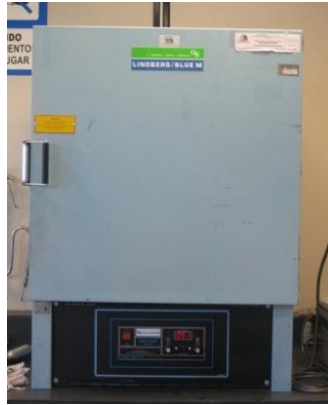
Figura 4.5 Secado de muestras de roca en la estufa de convección.
