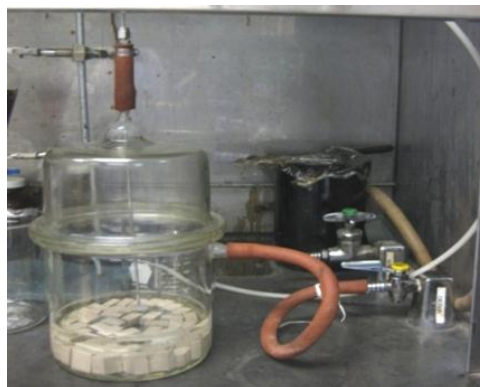
Figura 4.4 Limpieza de muestras en una cámara de vacío.
