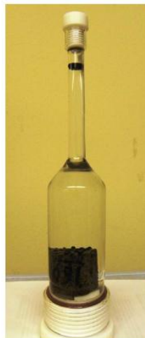
Figura 2.1 Celda de imbibición con acumulación de aceite en el cuello.
