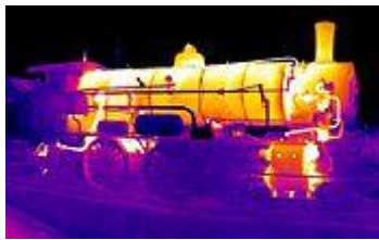
Ilustración 2- 3 Imagen en pseudocolor de una locomotora, las zonas amarillas representan mayor energía calorífica desprendiéndose Fuente: http://en.wikipedia.org/wiki/File:ParowozIR.jpg consultado Enero 2014
