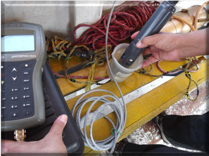
Figura 16. Determinación de parámetros in situ (O.D, S.T.D., P.O.R., C.E, Salinidad) mediante el multiparamétrico HANNA HI9828
