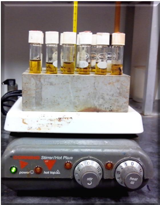
Figura 18. Determinación de DQO por el método (reflujo cerrado.)
