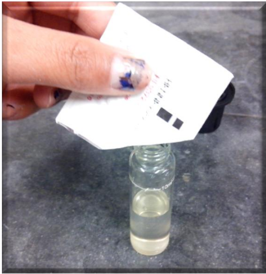
Figura 19. Adición de reactivo para el método de Cl libre en HANNA HI83200
