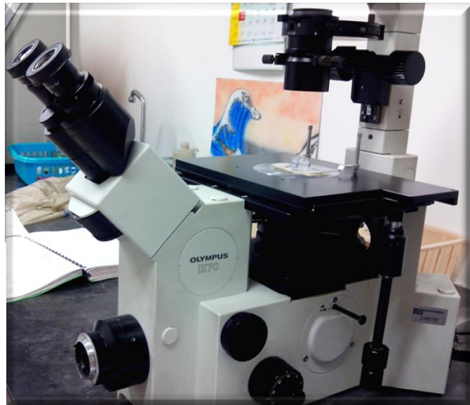
Figura 23. Análisis cuantitativo de fitoplancton por el método de Utermöhl, 1948 en Microscopio Invertido Olympus Ix70.
