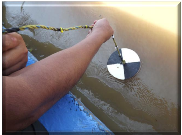
Figura 17. Determinación de Transparencia mediante el uso del Disco de Secchi
