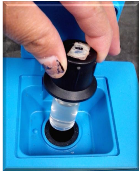
Figura 20. Celda con muestra y reactivo listas para ser leída dentro de HANNA HI83200.
