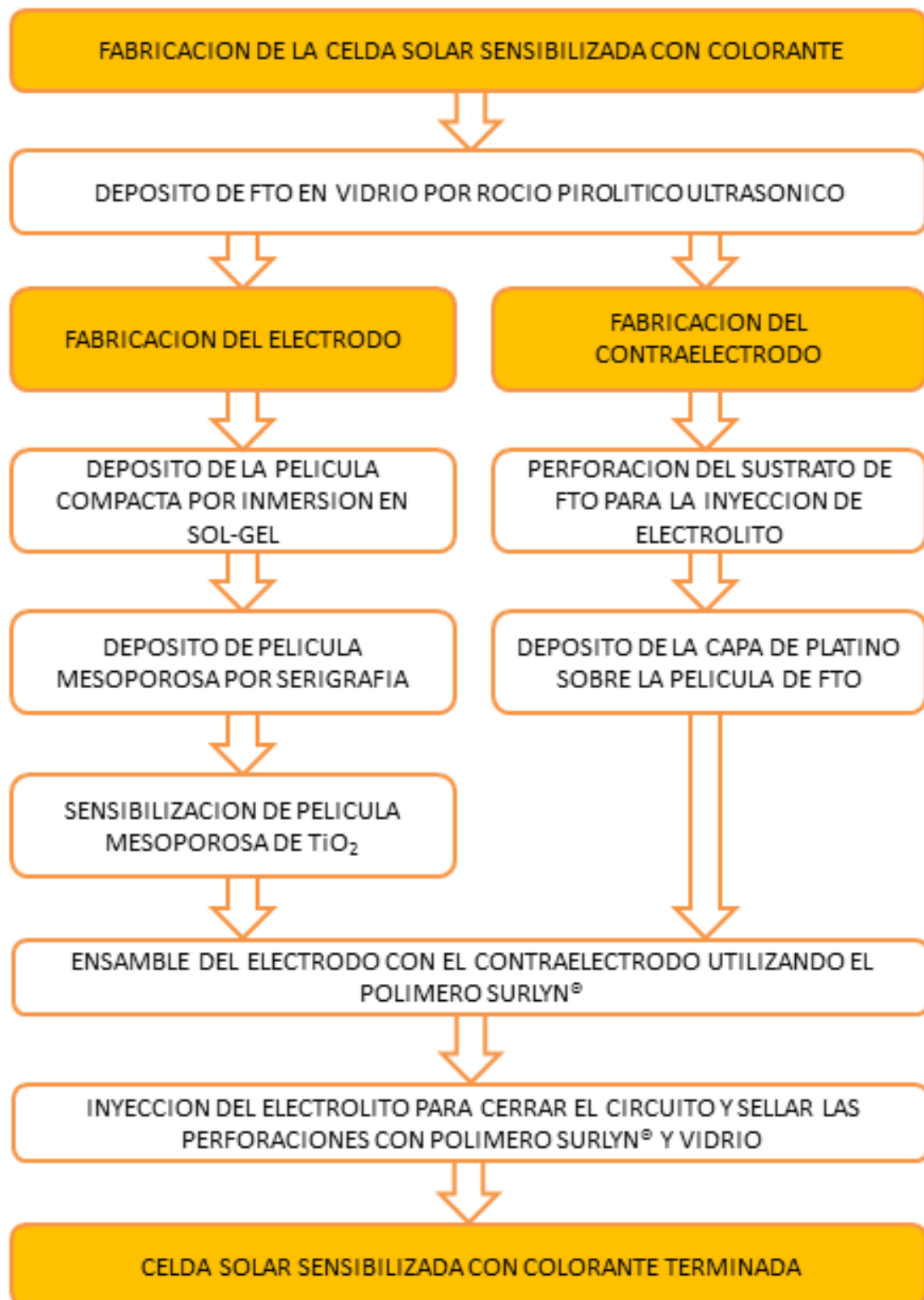
Figura 4.9 Diagrama de flujo empleado para la fabricación de celdas solares tipo DSSC
