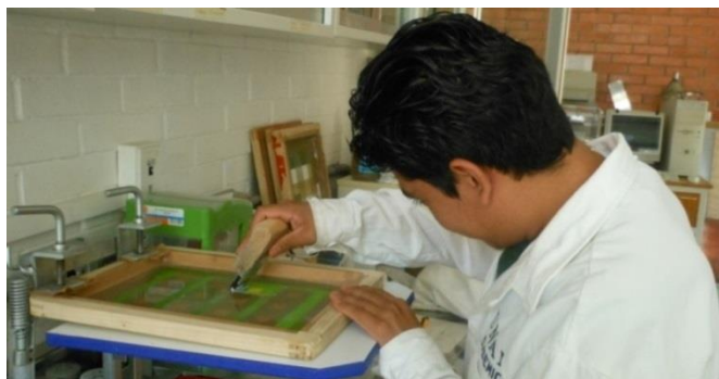
Figura 4.8 Depósito por serigrafía de una película mesoporosa de \text{TiO}_2
