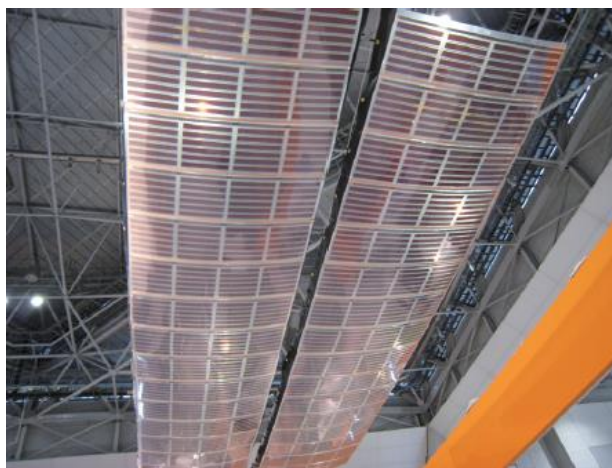
Figura 1.15 Ejemplo de un módulo fotovoltaico fabricado con celdas solares tipo DSSC (fuente: Kawakita 2010)
