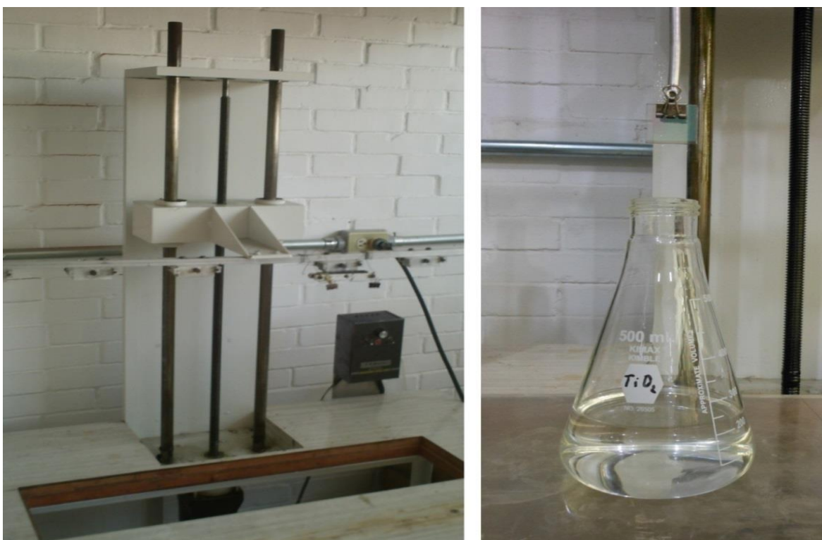
Figura 4.3 Fotografías del equipo de inmersión en sol-gel empleado
