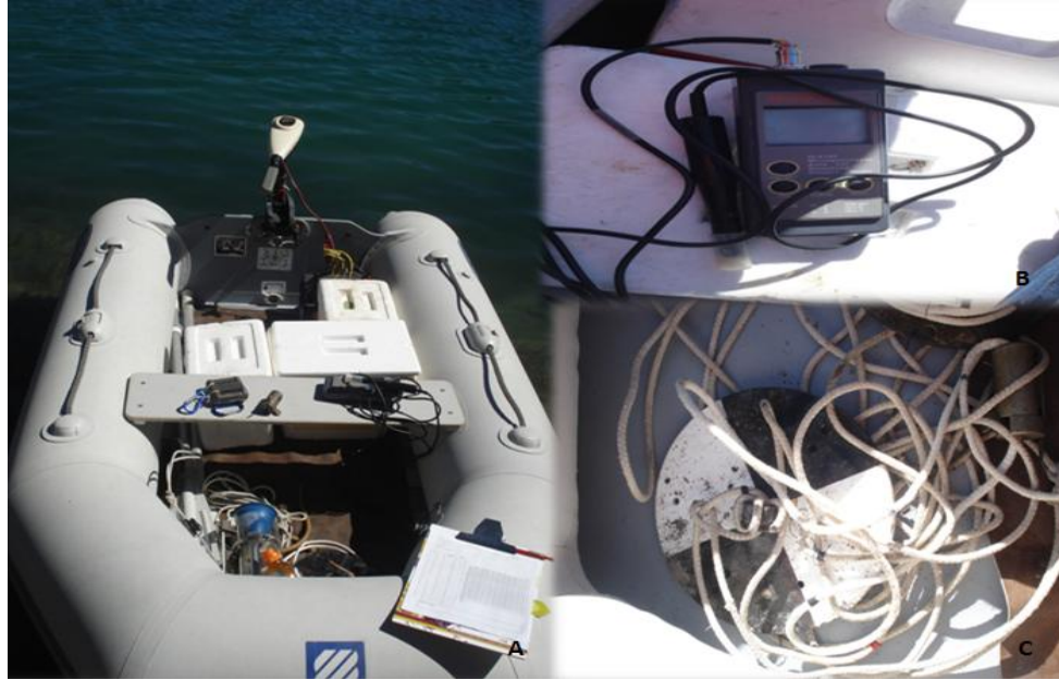
Fig. 5. Material de campo. A) Lancha, B) Oxímetro, C) Disco de Secchi.
