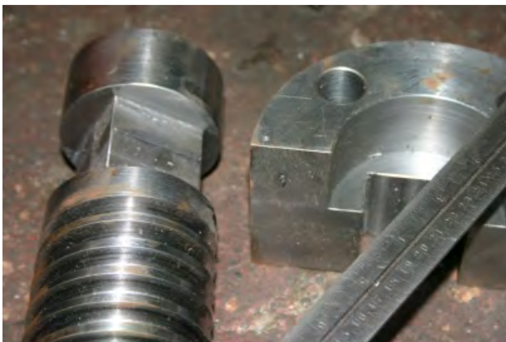
Figura 4.3. Usillo del marco deslizante.
