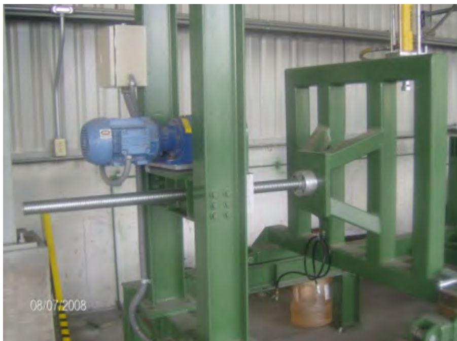
Figura 4.64. Marco desplazamiento para acoplamiento espiga-campana.
