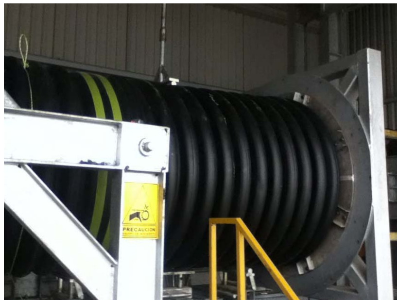
Figura 4.74. Tubería de 48 pulg sometida a las pruebas de hermeticidad.
