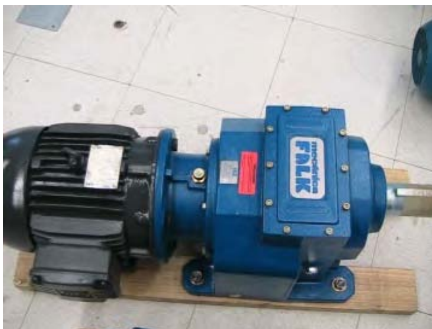
Figura 4.17. Motorreductor para el marco deslizante.
