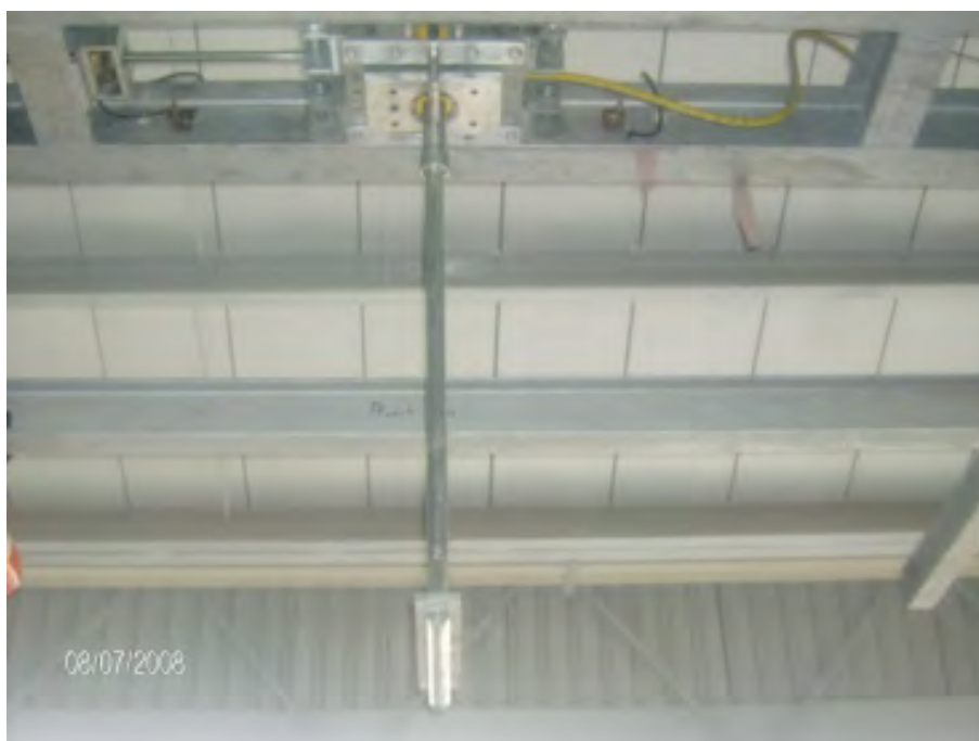
Figura 4.52. Sistema de carga para prueba de deflexión.
