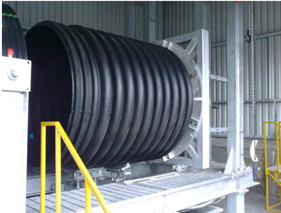
Figuras 4.79. Colocación de probetas de 60 pulg en el equipo EPH-60.
