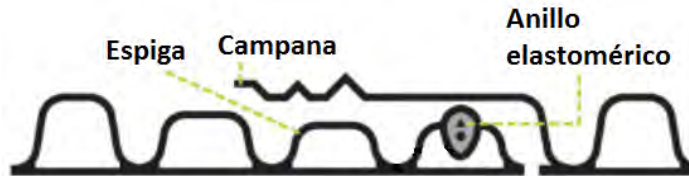
Figura 1.8. Unión tipo espiga-campana en tubería de PEAD.
