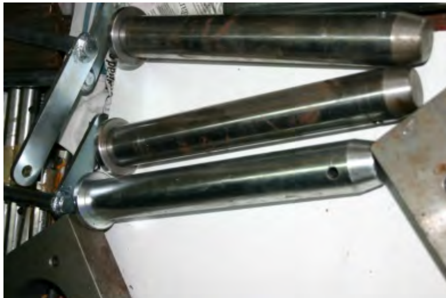
Figura 4.6. Pernos para marco pivote.
