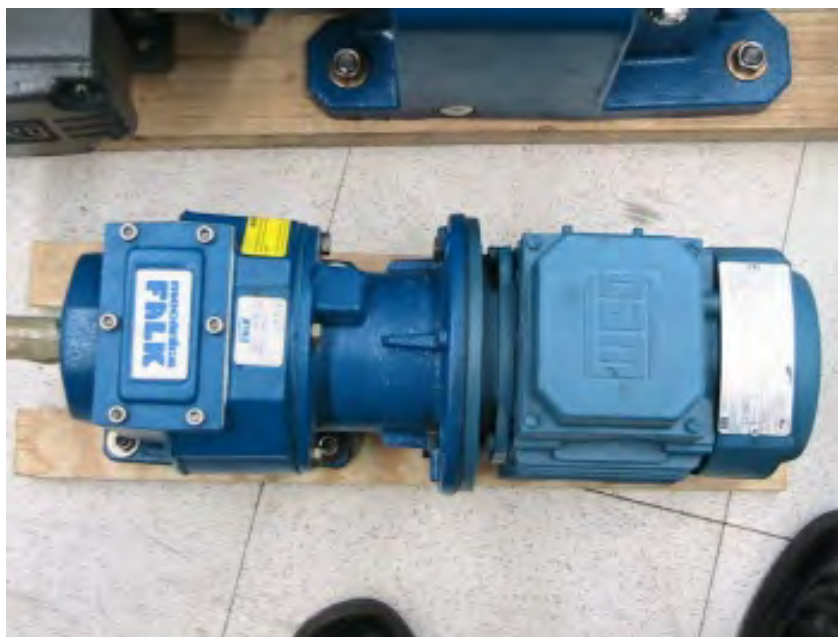
Figura 4.16. Motorreductor para posicionar la barra de carga.
