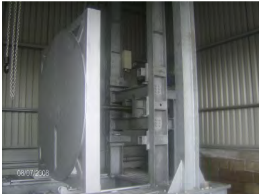
Figura 4.51. Marco para desplazamiento para acoplamiento espiga-campana.
