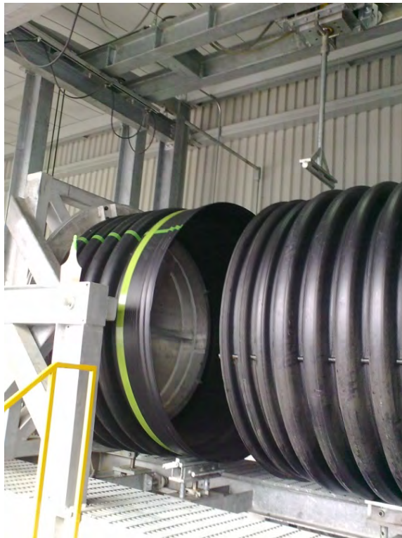
Figura 4.78. Colocación de probetas de 60 pulg en el equipo EPH-60.
