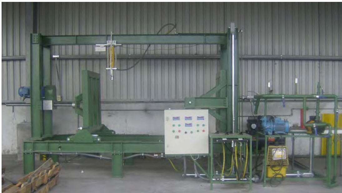
Figura 4.63. Equipo de hermeticidad EPH-24 en planta.
