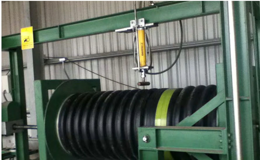
Figura 4.75. Prueba de hermeticidad a tubería de 24 pulg.
