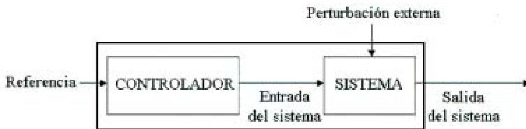
Figura 2.1.2 FIGURA REPRESENTATIVA DE UN SISTEMA DE LAZO ABIERTO
