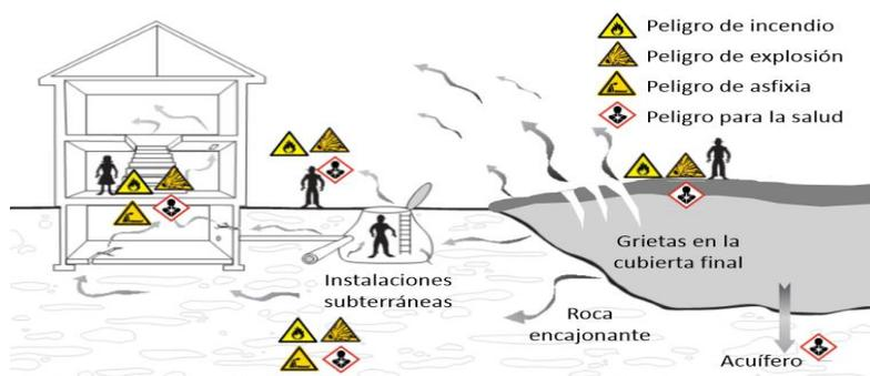
Fig.3. Diagrama de riesgo a causa del flujo de los gases en el ambiente (Villanueva et al., 2014)
