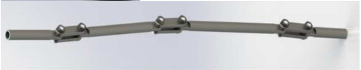
Ilustración 14 Miembro locomotor de acero (articulaciones de doble movimiento)
