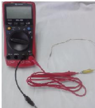
Esquema 3. Conexión de los electrodos en los bornes del multímetro para realizar las valoraciones
