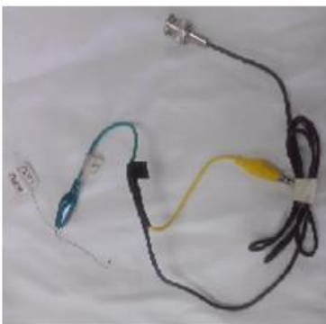
Esquema 2 Conector BNC con salida caiman-caiman
