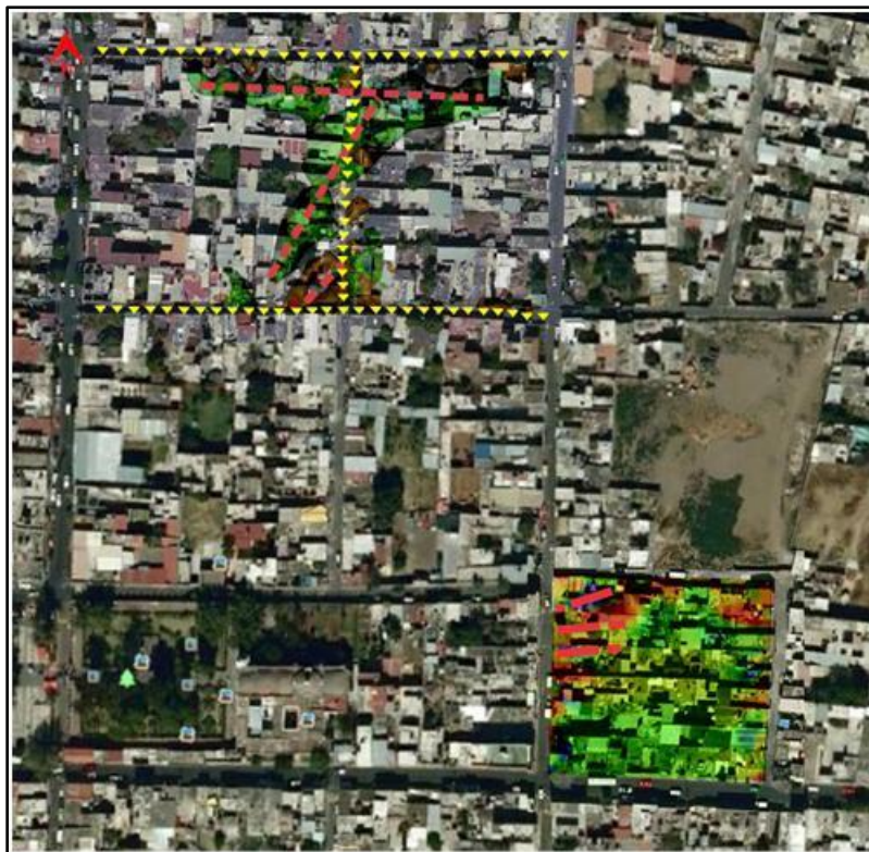
Figura 5.15 Vista regional del fracturamiento, se observa la tendencia NE-SW
