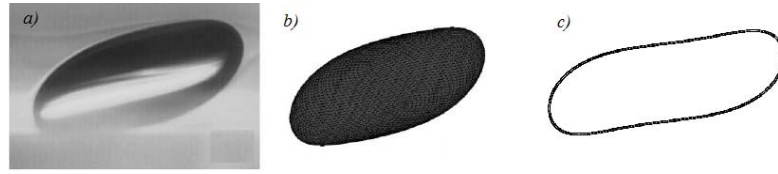
Figura 5.16: Formas de gotas deformadas obtenidas por Anderson et al. (a y b) y la obtenida en este trabajo (c), para \lambda = 1 , Ca = 0.2 y d/g = 0.9 .
